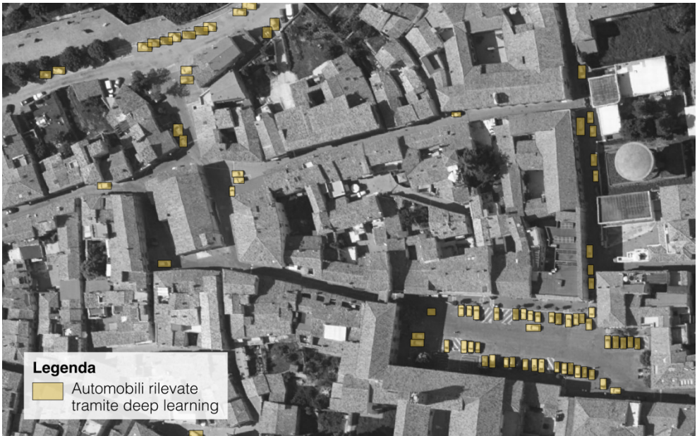
Figura 3 | Risultato dell’analisi automatica dell’ortofoto tramite deep learning
