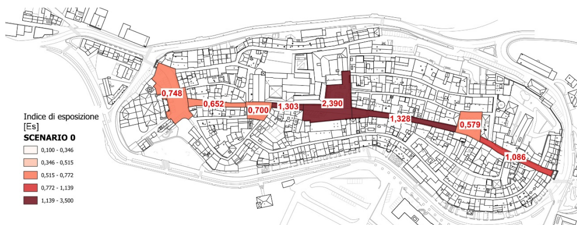
Figura 4 | Risultati dell'applicazione del metodo (Figura 2) allo stato di pre-sisma (Scenario 0).
